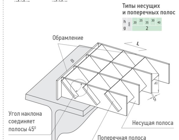
**Угол наклона соединяет полосы 45°**
