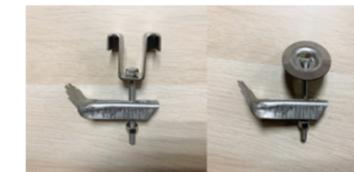
2. Комплект крепления двойной из нержавеющей или оцинкованной стали для GFK настила (М-образная скоба или тарелка – 2 шт, прижимная планка – 1 шт, болт М8\*60 – 2 шт, шайба М8 – 2 шт, гайка М8 – 2 шт):
