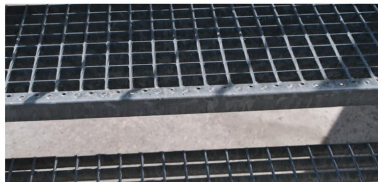
К ступенькам предъявляются более высокие требования в отношении безопасности против скольжения, чем к решёткам. Ступеньки поэтому всегда изготавливаются с имеющим отверстия кантом, на который ступают. Кроме повышенной безопасности при постановке шага ступеньки получают также более высокую стабильность.
